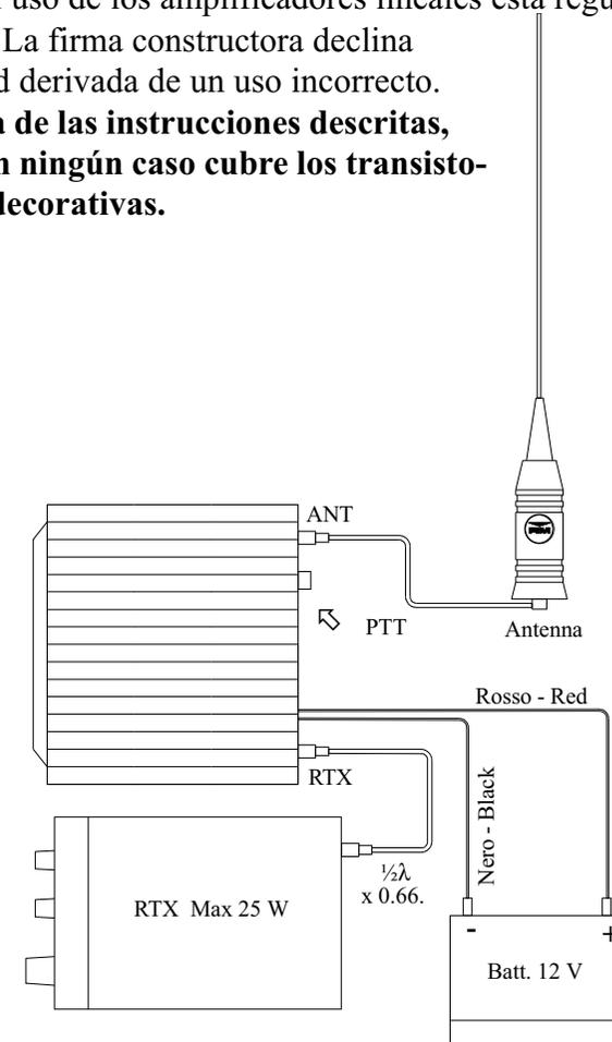
Das Kabel (RG 8 - RG 213) muß 50 Ω sein, um Verluste zu vermeiden. Achten Sie darauf, daß sämtliche Steckverbindungen von hoher Qualität sind. (Teflon-Isolator).
