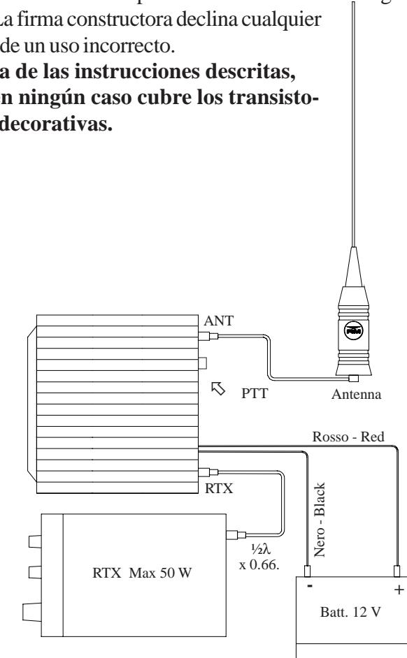
Das Kabel (RG 8 - RG 213) muß  $50 \Omega$  sein, um Verluste zu vermeiden. Achten Sie darauf, daß sämtliche Steckverbindungen von hoher Qualität sind. (Teflon-Isolator).
